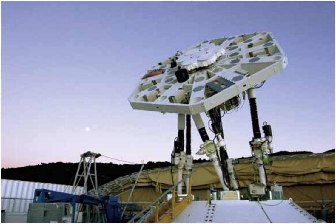
圖1：AMiBA的7天線陣列階段。平台直徑約6米，天線直徑則為0.6米。平台下方為目前世界上最大的用於天文觀測的六腳基座（hexapod mount）。
